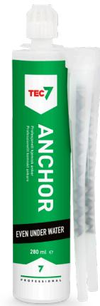
ANCHOR er et kjemisk anker for robust og langvarig montering og festing. ETA-sertifisert for bruksområder, brannsertifisert og vannrett. Kan brukes fra -10 °C til +40 °C, på fuktige flater, under vann og innendørs. Herder raskt uten krymp/ekspansjon, blir sterkere enn underlaget og tåler høye belastninger. Er motstandsdyktig mot UV-stråler, kjemikalier, klor og saltvann.
