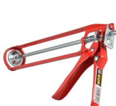
101 GUN er støtsikker og passer til alle standard fuge- og limpatroner. Den har kraftoverføring 7:1 for lett pumping og jevn mengde, og anti drip funksjon for bedre presisjon og mindre sør. 101 GUN har integrert punkteringsverktøy som brukes hvis massen har herdet i dysen etter forrige gangs bruk. Den har også zinkbelagt stålramme og håndtak, samt korrosjonsbeständig stempel og glidekomponenter.
