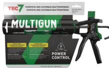
Solid og profesjonell fugepistol med justerbar kraftoverføring, for alle standard 290-310 ml lim- og fugepatroner. Pistolen kan endre trykkraft fra 12 til 25 kg og reduserer dermed behov for ekstra muskelkraft ved tykke masser, samtidig som den også fungerer optimalt på mykere masser. Dette forenkler arbeidet ved mindre fysisk anstrengelse og mer presis påføring.
