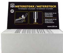
101 METERSTOKK har 2 meter lengde, reversibel skala for avlesning begge veier og både vinkel- og dybdemåler. Dypt preget avmerking ned til millimeter og desimeter markert med røde tall. Nøyaktighet iht. EU-Standard accuracy class III. Produsert i 30 % glassfibersterket Polyamid-materiale for lang levetid og er motstandsdyktig mot skraping, samt de fleste kjemiske stoffer og vann/fukt.
