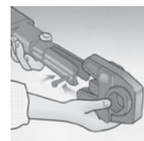
Monter korrekt kjelt for pressverktøyet, ifølge vedlagte tabell.
