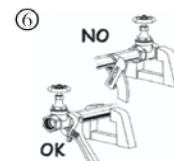
6 For å forhindre forvrengning og skade på bevegelige deler, sett ikke sluseventiler i skrustikke på arbeidsbenk. Sett heller røret i skrustikke og skru sluseventilen på plass.
