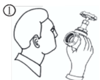
1 Inspisere sluseventilens gjenger for smuss før installasjon. Smuss kan skade ventilsetene og forårsake lekkasjer.
