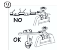
9 Når toppdekselet monteres på sluseventilens kropp er det spesielt viktig å stramme forsiktig for å hindre at pakningen som er plassert mellom disse 2 delene blir ødelagt.
