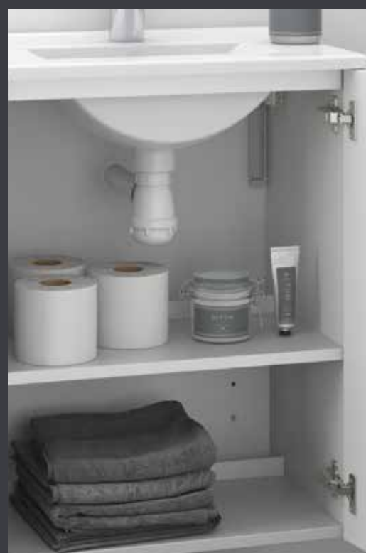
Bunnen og hyllen i servantskapet er trukket 55 mm fremover, noe som gir plass for avløp til gulv uten boring. En aluminiumskant bak forhindrer at ting faller ut.
