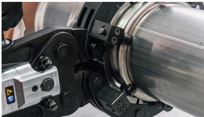
Bilde 35 – Montering av press, 2. fase
